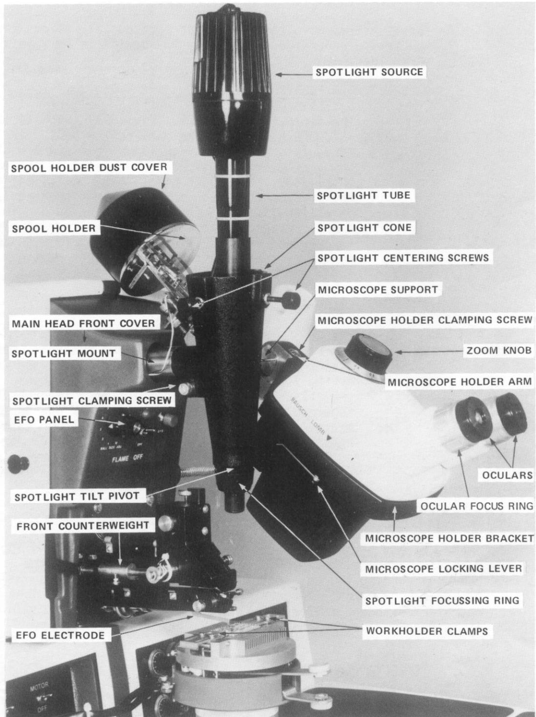
FIGURE 3-2 MODEL 4124 BALL BONDER – FRONT PARTS
