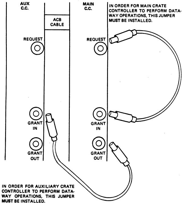
AND THE ACB CABLE MUST BE CONNECTED BETWEEN THE MAIN AND AUXILIARY CONTROLLERS.
