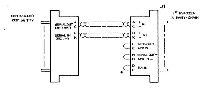
RECOMMENDED CONNECTION OF CONTROLLER TO 15T HV4032A OF DAISY-CHAIN FOR CABLE LENGTH BETWEEN 250 AND 1000 FEET.
